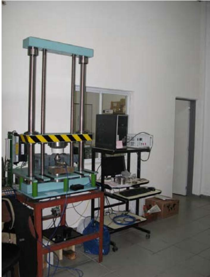
Luego sigue la aplicación de sensores de deformación sobre los cuerpos y la realización de una cantidad de ensayos para medir su desviación frente a los parámetros buscados y la compensación de los errores. Es física pura.
