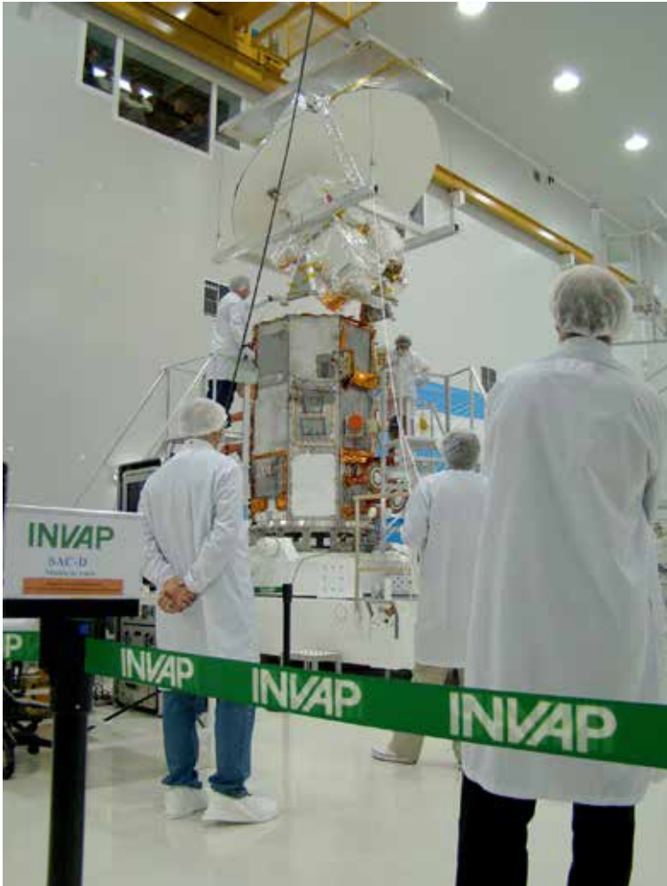
Integración del instrumento Aquarius en la Sede Central de INVAP. 2010.
