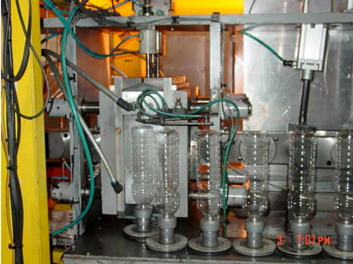
Primer Maquina Sopladora de PET construida en nuestros talleres.
