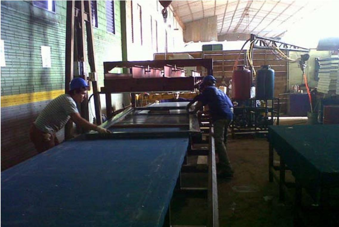
Tareas de producción de paneles aislantes en una prensa calefaccionada.
