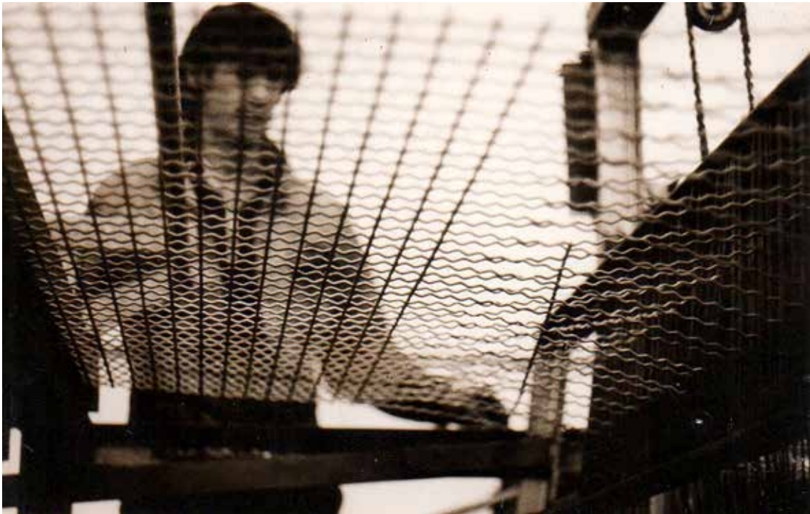
Telar para producción de mallas de acero.
