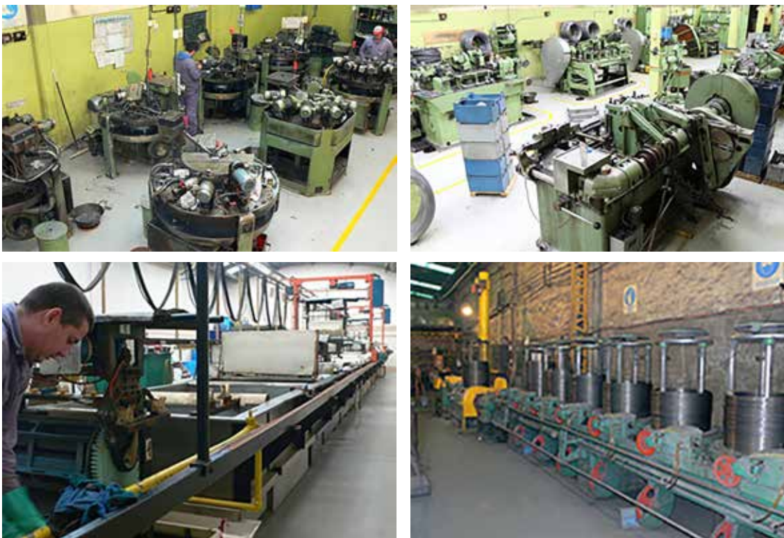
De izquierda a derecha y de arriba a abajo: máquinas de niples; máquinas de rayos; máquina de zincado y máquina de trefilado.
