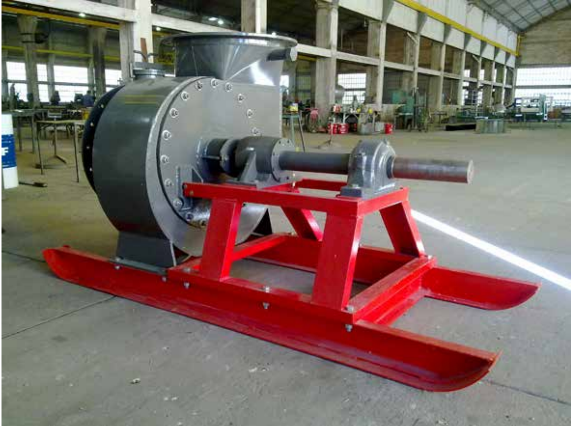
Bomba centrífuga para el riego de arroz.
