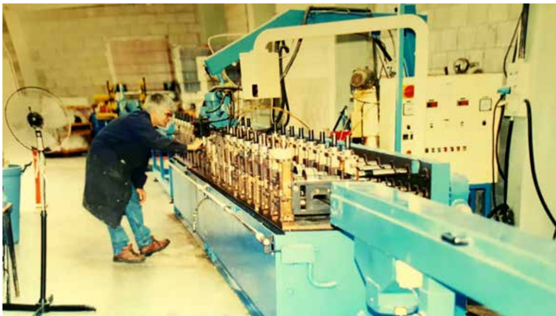
Inspeccionando la primera conformadora de tablillas que instalamos. Año 2002.
