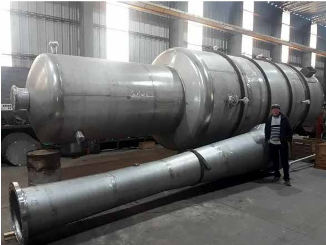
Equipos: desodorizador y eyector en acero inoxidable.
